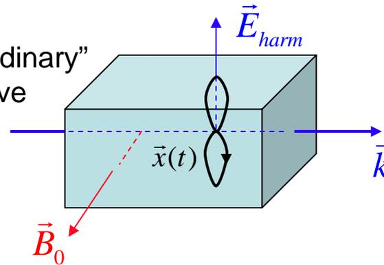
$$\begin{bmatrix} P_x \\ P_y \end{bmatrix} = -n_e e \begin{bmatrix} x \\ y \end{bmatrix} \quad \text{and} \quad \begin{bmatrix} x \\ y \end{bmatrix} = \frac{e^2}{m\omega^2} \begin{bmatrix} E_x - i\omega y B_0 \\ E_y + i\omega x B_0 \end{bmatrix}$$
